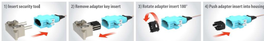
El adaptador de polaridad intercambiable MPO de Senko permite al operador extraer un inserto interno utilizando la herramienta de cambio de polaridad (P / N RMT-609) para conectores MPO planos pulidos.
