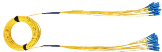
Manguera 12 F.O. LCUPC con cable CP-DC 3 mm y fan-out 12x1.6 mm
