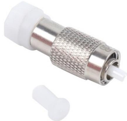
Los atenuadores de fibra óptica son dispositivos pasivos en forma de conector macho-hembra que permiten reducir la cantidad de potencia en una señal, y así dar una estabilidad a una señal de fibra óptica.
